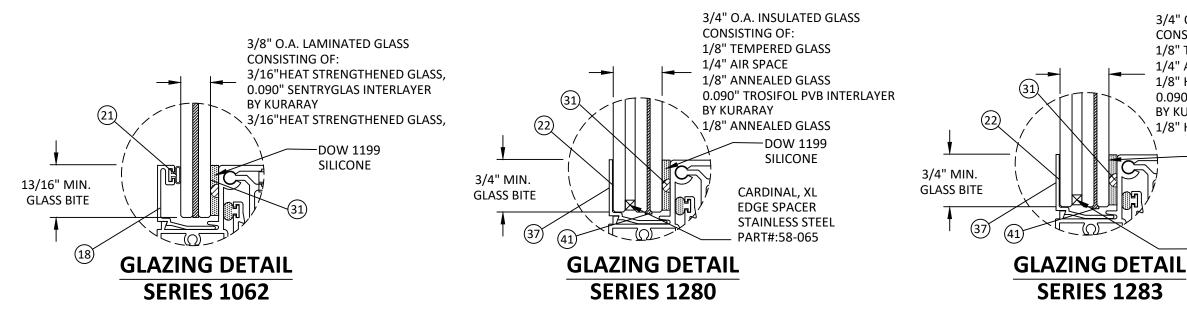
SETTING BLOCKS TO BE LOCATED AT 1/4 SPAN LENGTH FOR
